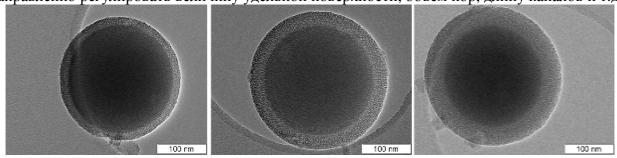
Рисунок 1 Микрофотографии частиц с различной толщиной мезопористой пленки
