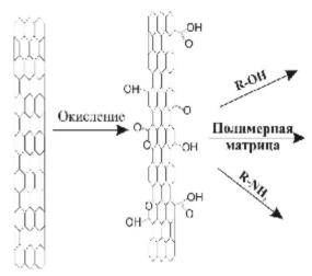
Рис. 1. Химическая функционализация поверхности углеродных нанотрубок.
