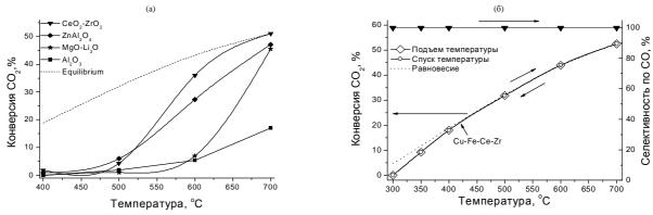
Рис. 2 Конверсия  $CO_2$  на катализаторах: (a) -  $CeO_2$ - $ZrO_2$  в сравнении с  $ZnAl_2O_4$ , MgO- $Li_2O$  и  $Al_2O_3$  в зависимости от температуры; (б) - Cu-Fe-Ce-Zr при спуске и подъеме температуры. Состав исходной газовой смеси, об. %:  $CO/CO_2/H_2/H_2O$ =5/30/60/5, P=1amm., GHSV=10000 u-1.
