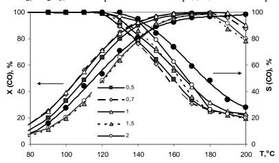
Рис. 2. Каталитические свойства АМЦ-0 ( $\bullet$ ) и ПСТ-образцов.
