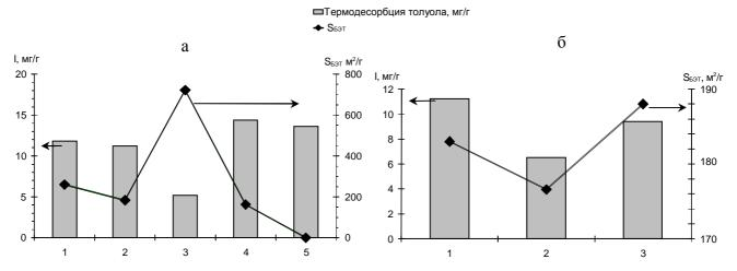
Рис. 1. Термодесорбция толуола с образцов адсорбентов, исходных носителей, и их поверхность: а): 1- исходный Сибунит; 2 — Сибунит, предобработанный азотной кислотой; 3 —  $SiO_2$ ; 4 —  $5\%SiO_2$ /Сибунит; 5 — 0.5% Fe/Сибунит; б): 1 - Сибунит, предобработанный азотной кислотой; 2 — 3% Ni/Сибунит с KBУ; 3 — 2.3% Co/Сибунит с KBУ.
