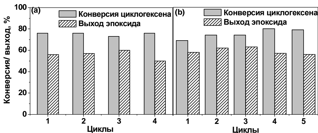
Рис. 7. Повторное использование катализаторов в окислении циклогексена: (а) PW_4/MIL-101 и (б) PW_{12}/MIL-101 (способ А).
