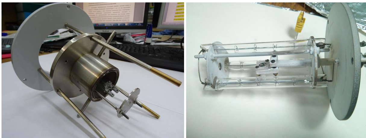
Рисунок 6. Фотографии деталей рентгеновской камеры-реактора до нанесения инертного покрытия (слева), в сборе с установленным образцом(справа).
