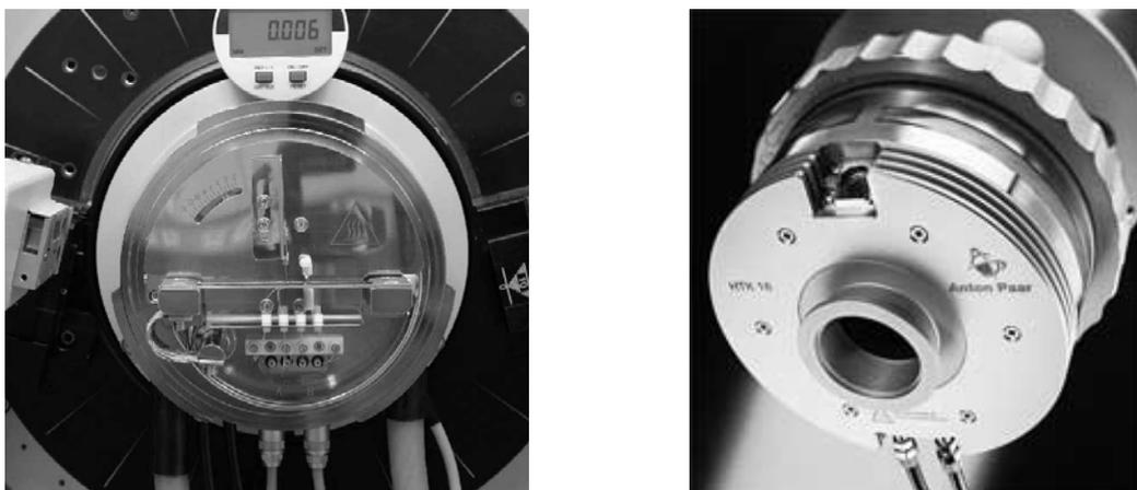
*Рис. 2.1.1. Высокотемпературная камера с металлической пластиной–нагревателем. Anton Paar HTK-16.*
