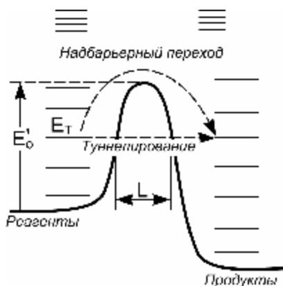
Рис. 4.11. Схематическое изображение надбарьерного перехода и процесса туннелирования частиц сквозь потенциальный барьер
